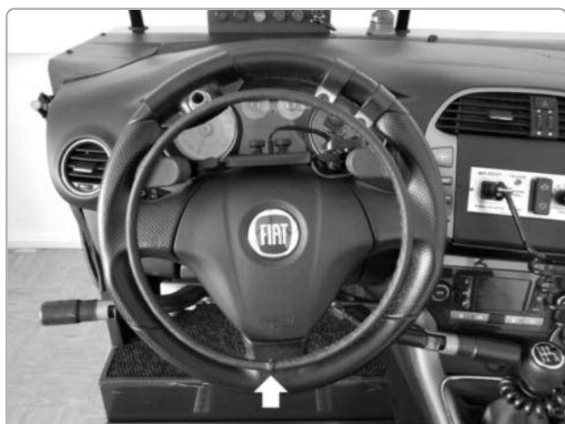
Figura 2 - Acelerador manual - aro adaptado ao volante (seta branca).
